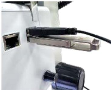
顯微鏡的右側有兩個 USB 連接埠。它們可用於連接 USB 設備，例如隨附的有線滑鼠、或自備的無線鍵盤組和儲存設備。使用隨附的滑鼠來導航顯微鏡的軟體。插入顯微鏡右側的任一 USB 連接埠。
