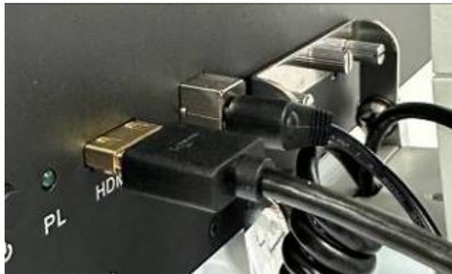
支架後方的顯微鏡連接有兩根電纜，包括 HDMI 和電源。將每條電纜插入顯示器上對應的連接埠。
