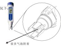
减少气泡的放法:短暂的将电极浸润入溶液中,并拿出甩掉气泡。
